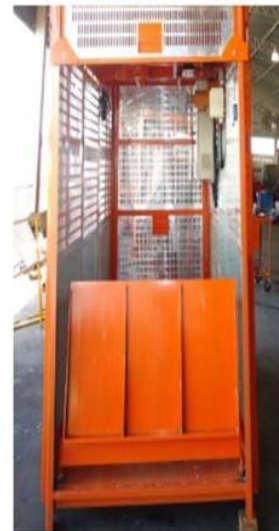
Rampa de Acesso LEVANTADA
