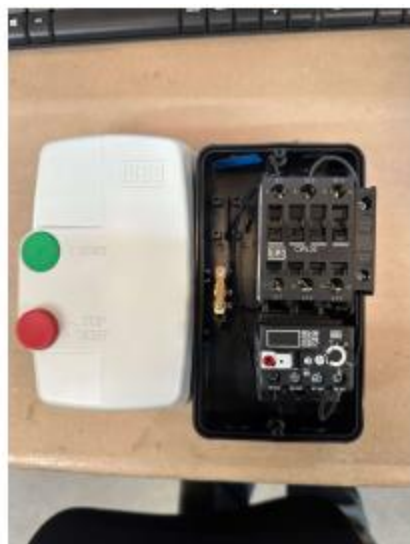
Sistema anterior com 1 contator e relê com botão liga e desliga
