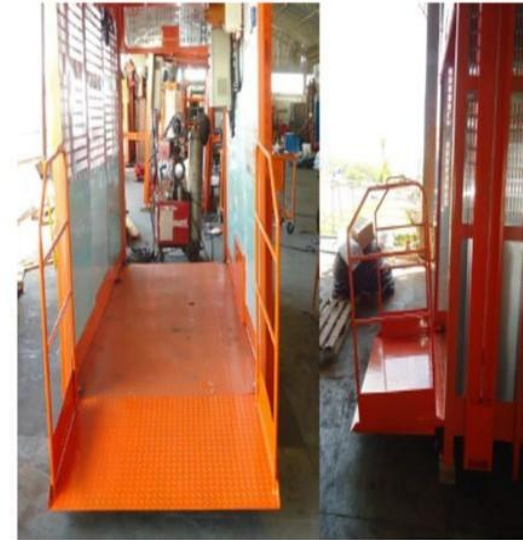
Rampa de Acesso ABAIXADA
